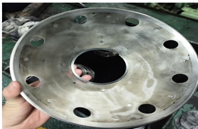
Gambar 4.9. bowl disc yang sudah dibersihkan menggunakan solar
