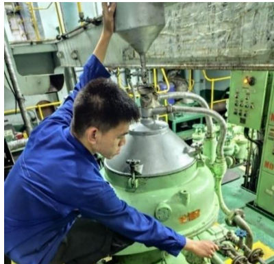
Gambar 4.5. Proses Blow-Up pada L.O Purifier
