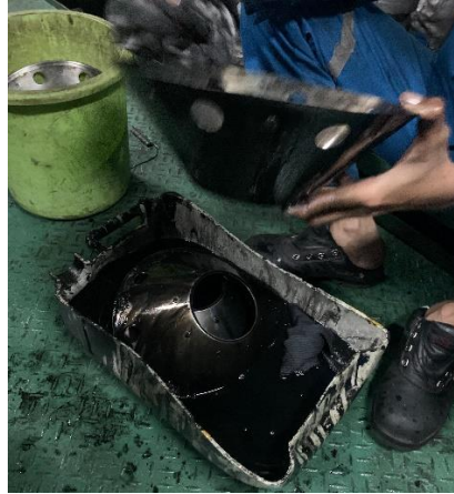
Gambar 4.7. Proses pembersihan bowl disc menggunakan solar
