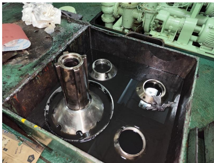
Gambar 4.8. Proses perendaman part purifier menggunakan solar
