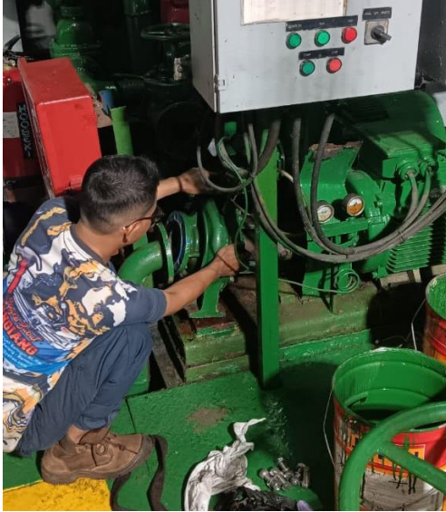
Mengganti bearing baru dan diberi grease
