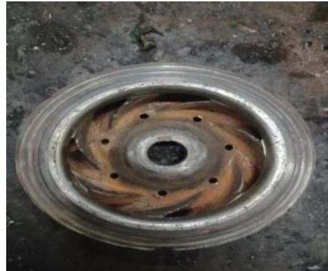
Mengganti impeller yang terkikis
