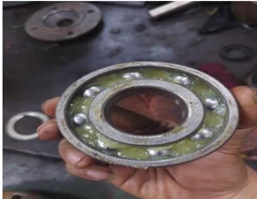
Mengganti bearing baru dan diberi grease
