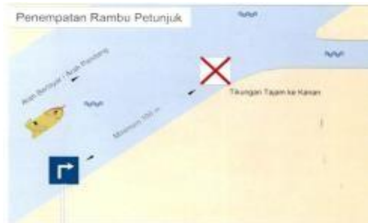
Gambar 4. 17 Ilustrasi Pemasangan Rambu Sungai
