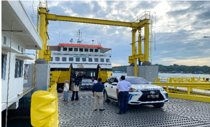
Gambar 4. 35 Proses Muat Kendaraan dengan Metode Mundur
