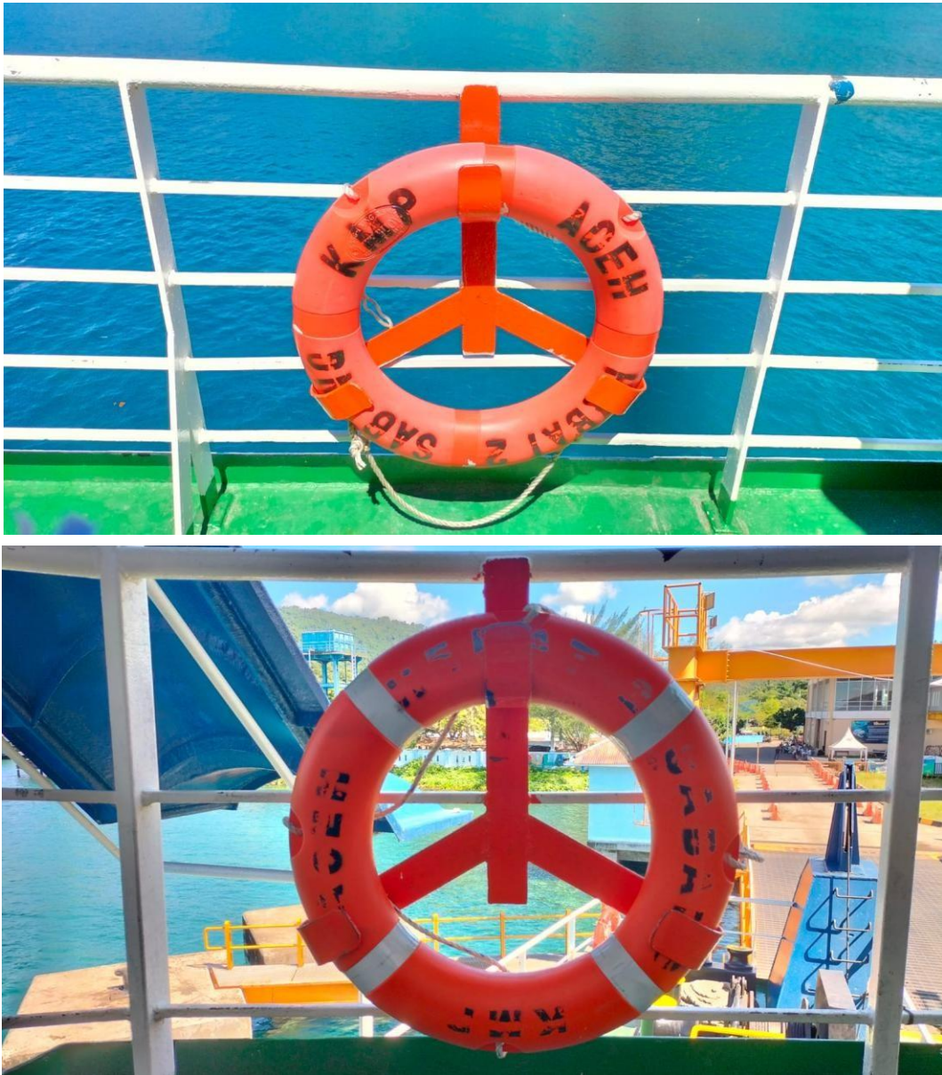
Lampiran 4 Gambar Lifebouy yang sudah memudar
