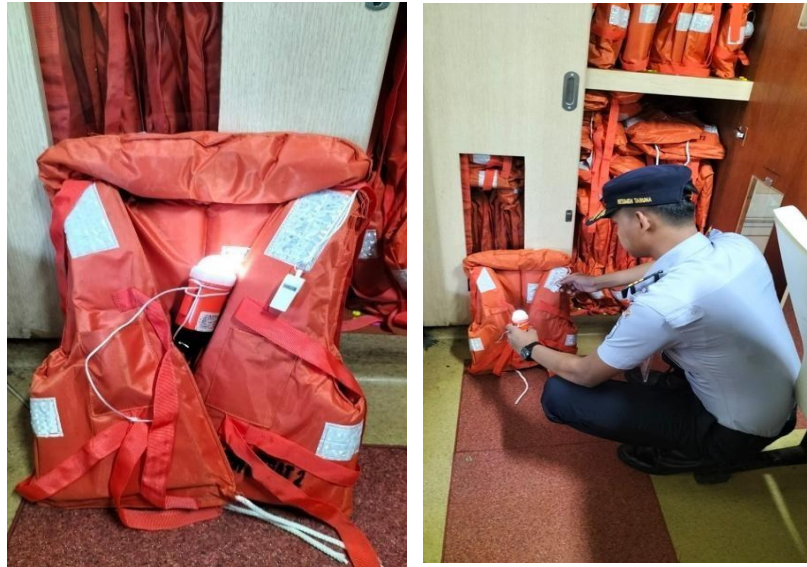
Gambar 4. 17 Kondisi lifejacket di KMP. ACEH HEBAT 2 Yang Dilengkapi peluit, light reflector dan self igniting light
