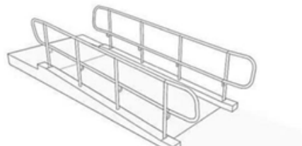
Gambar 2. 7 Bentuk Ramp Sumber: Peraturan Menteri Pekerjaan Umum dan Perumahan Rakyat Nomor 14 Tahun (2017)
