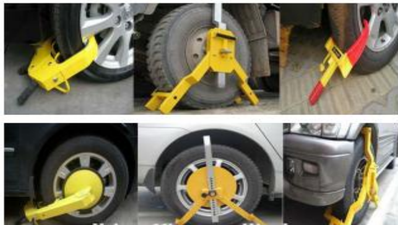
Gambar 2. 1 Jenis-Jenis Klem Roda Kendaraan Sumber : Lampiran Pada PM. Nomor 115 Tahun 2016
